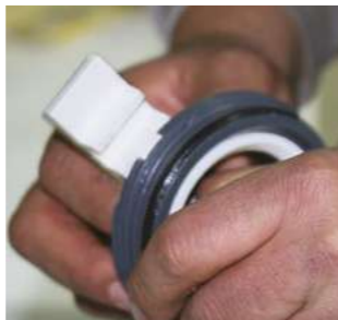
Dayama içindeki küre contası el ile çıkartılır.
