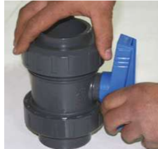
Dayama tarafındaki somun saat yönü tersine çevrilererek sökülür. Somun ve boru bağlantı alınır.
