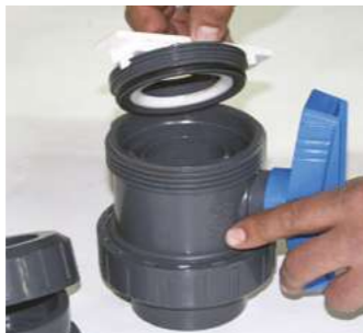
Sekman dışleri gövdeden kurtulduğunda kol kapağı ile birlikte ayrılacaktır.
