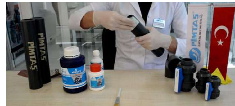
Boru ve soketin temizlenmesi
