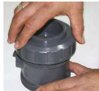
Gövde tarafındaki somun saat yönü tersine çevrilererek çıkartılır.
