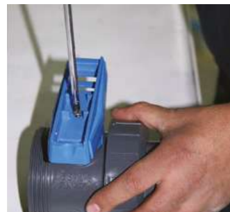
Kol üzerindeki vida yıldız uçlu bir tornavida yardımı ile sökülür.
