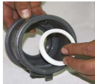
Gövde içindeki küre contası ile alınır.
