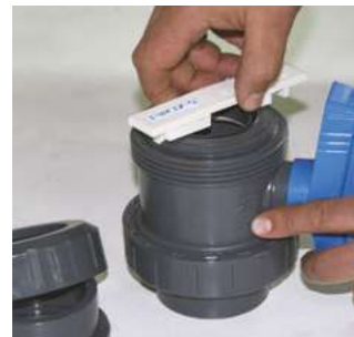
Sekman saat yönü tersine çevrilererek çıkartılır.
