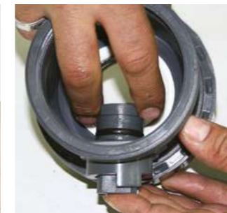
Pim dışarıdan içeriye doğru itilerek çıkartılır. Bu arada diğer el ile içerden tutulur. Yuvasından çıkan pim alınır.
