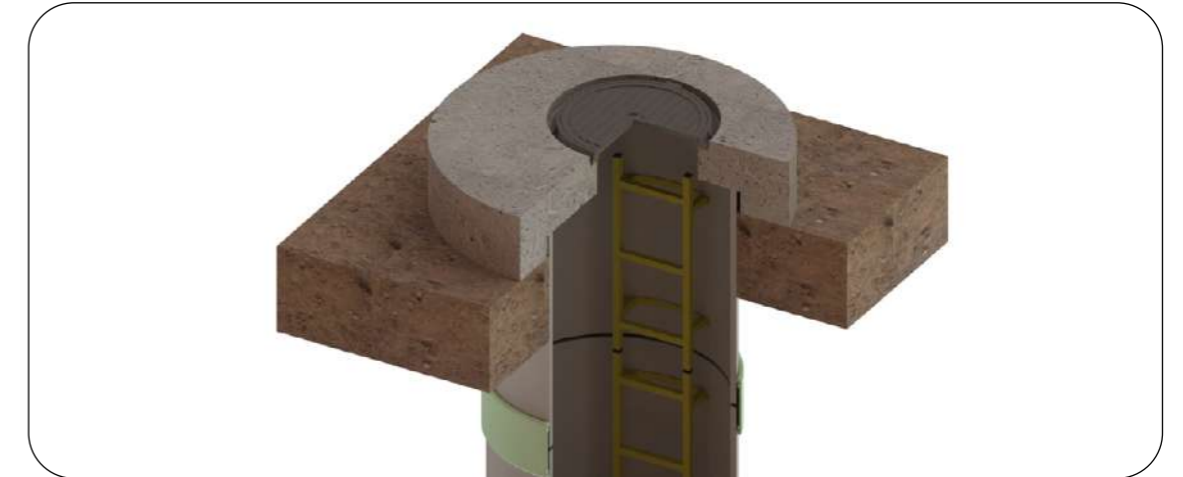
Menhol Kapağı Montajı
